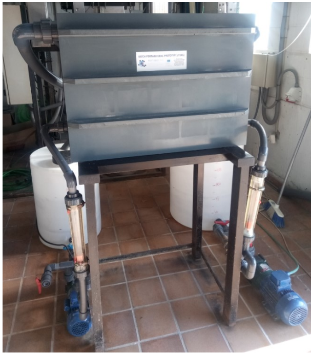
Fotografía 1: vista frontal del reactor electroquímico en la configuración de electrodos planos paralelos con una capacidad de tratamiento de 15kg.
