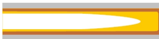
Figura 3. Etapa de compactación con gas.
