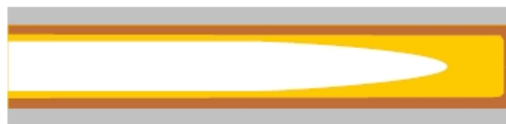
Figura 3. Etapa de compactación con gas.
