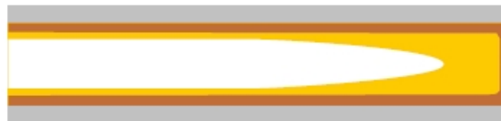
Figura 3. Etapa de compactación con gas.
