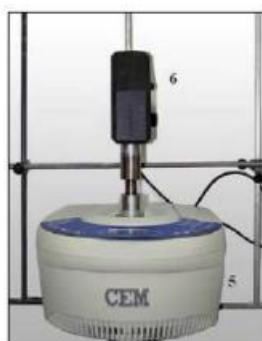
Figura 2. Sistema para irradiar microondas y ultrasonidos simultáneamente, consecutivamente o alternativamente, de forma directa sobre muestras sólidas o líquidas con ambos tipos de energía. (5) Sistema de microondas; (6) Sistema de ultrasonidos.
