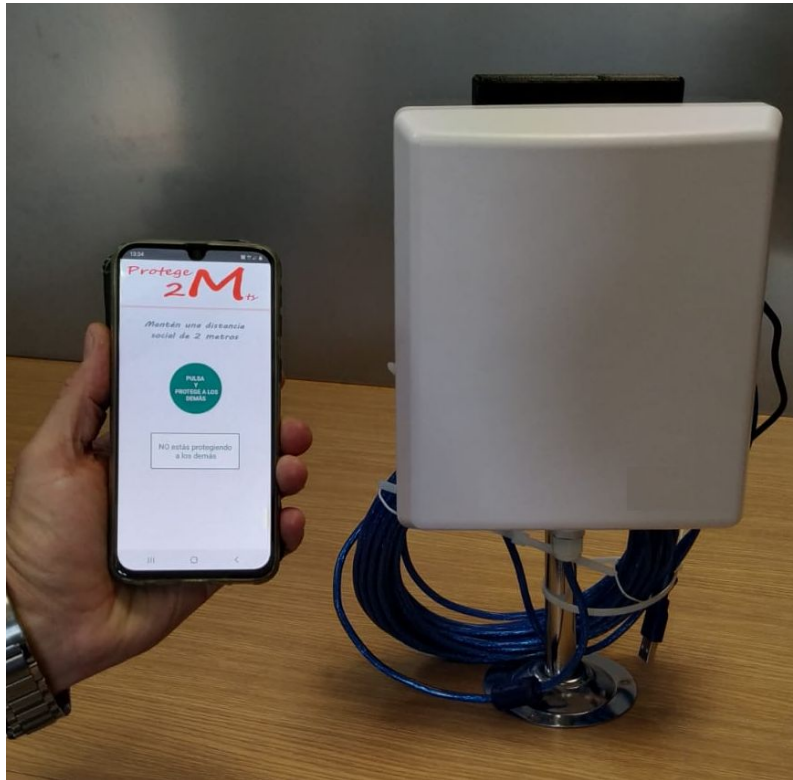
Figura 3. Sensor para la detección de smartphones.
