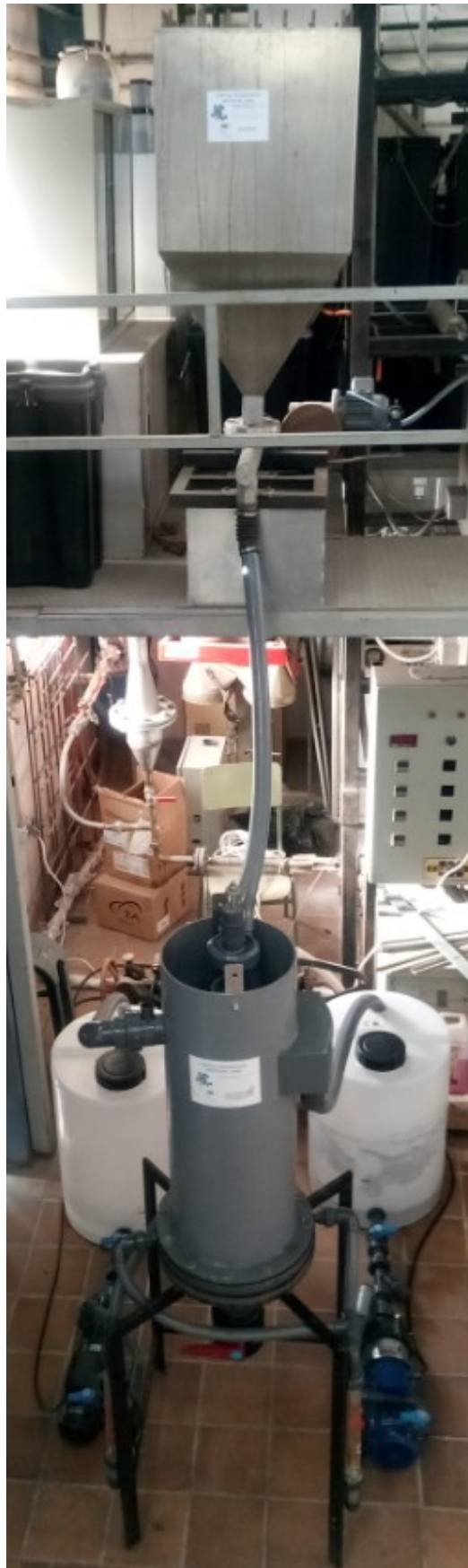
Fotografía 2: vista frontal del reactor electroquímico en la configuración de electrodos cilíndricos concéntricos con una capacidad de tratamiento de 10kg.
