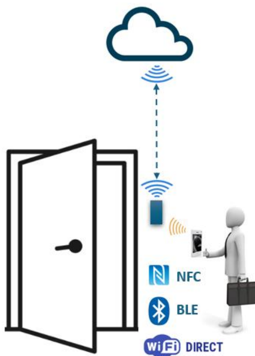
Fig 3. Arquitectura IoT para control de acceso distribuido
