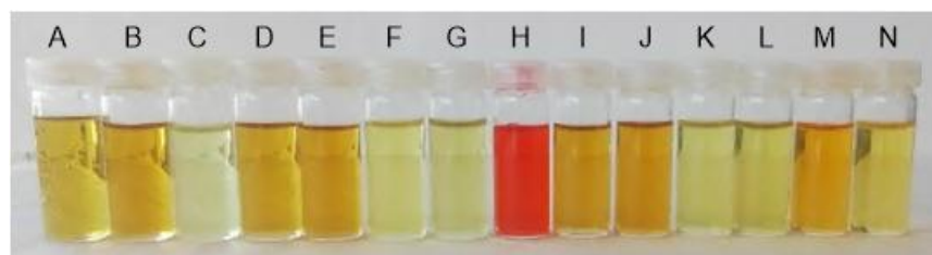
Figura 2: Test de detección selectiva de iones nitrito ( \text{NaNO}_2 , disolución H), frente a trece aniones, utilizando una 7-formilindolizina en medio ácido. Sales: KCN (A), \text{PhCO}_2\text{K} (B), KF (C), KCl (D), KBr (E), KI (F), KOAc (G), \text{K}_2\text{P}_4\text{O}_7 (I), \text{K}_3\text{PO}_4 (J), \text{KH}_2\text{PO}_4 (K), \text{NaN}_3 (L), \text{K}_2\text{S} (M) y NaHS (N). Todas las concentraciones son 10^{-4} M en acetonitrilo o acetonitrilo-agua.
