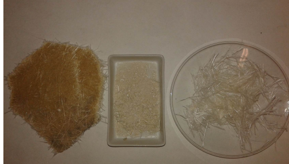
Izquierda. Material compuesto fibra-resina antes del tratamiento de recuperación de la fibra. Derecha: Fibra de vidrio recuperada tras el tratamiento químico. Centro: Residuo de resina degradada tras el tratamiento químico.
