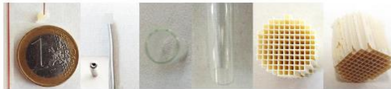
Figura 1. Materiales seleccionados, de izquierda a derecha: Capilar de sílice fundida (i.d. 0.25 mm), tubo acero inoxidable (i.d. 1.6 mm), tubo de vidrio (i.d. 7.6 mm), y monolito de cordierita multicanal (i.d.channel 1.2 mm)
