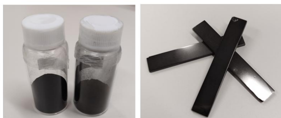
Imagen 1: Electrocatalizadores sintetizados en forma de polvo fino y soportes sobre los que se depositan, respectivamente.
