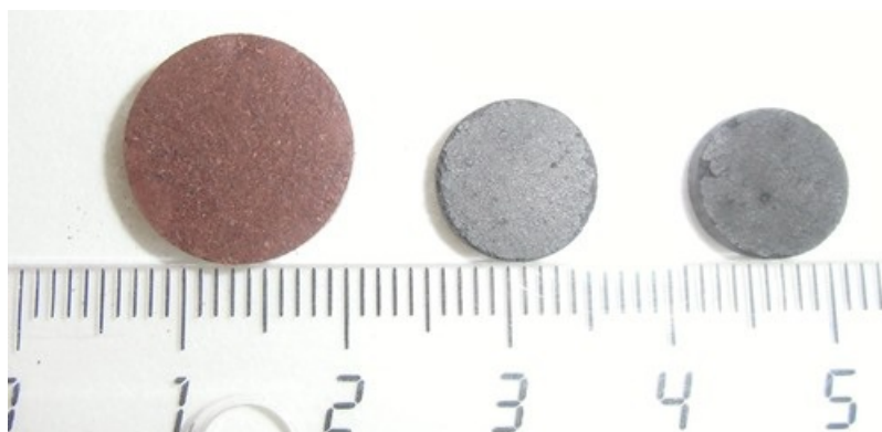
Figura 1: monolitos de carbón activo obtenidos a partir de cáscaras de cacao durante las distintas etapas de preparación (de izquierda a derecha: fresco, carbonizado y activado)
