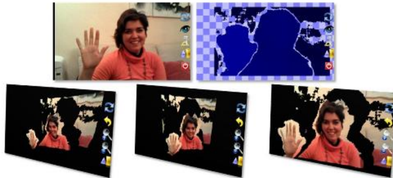
Figura 4. La tecnología empleada extrae del orden de 30000 medidas reales del entorno por cada frame, a razón de 9 frames por segundo. Imagen de referencia (arriba izquierda) imagen de profundidad calculada (arriba derecha) y distintas perspectivas de la escena en 3D correspondiente (abajo).
