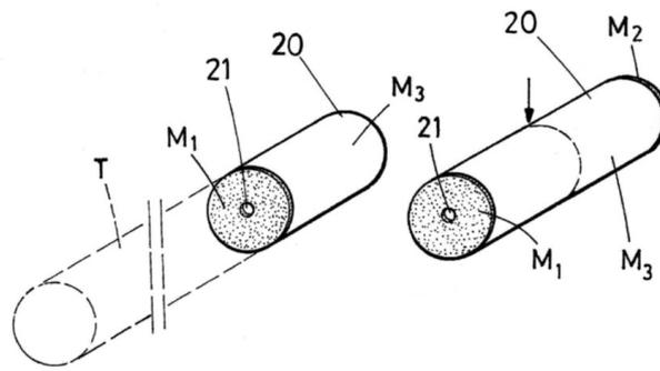
Figura 2: vista en perspectiva de las posibles configuraciones del filtro.
