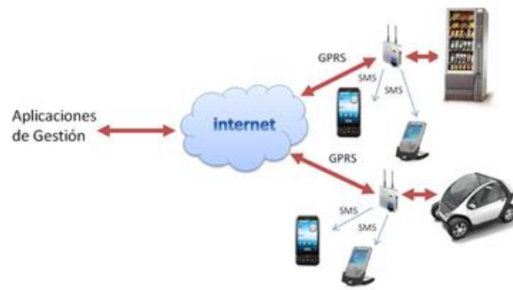
Figura 3. Esquema de flujos de comunicación
