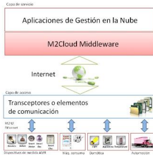
Figura 1. Esquema general del sistema
