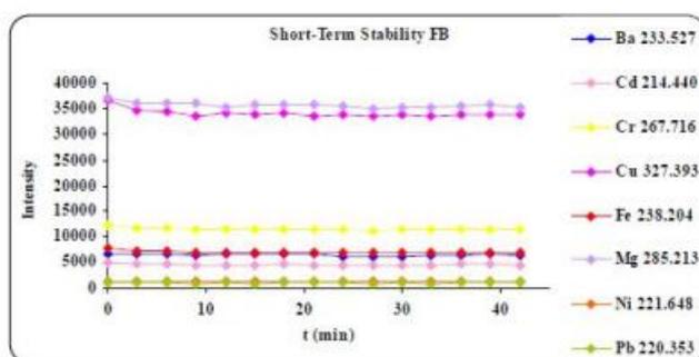
**Figura 3.** Estabilidad a corto plazo obtenida para el FBN usando una disolución acuosa que contiene 0.5 M  $\text{HNO}_3$  y 1 mg/L de cada uno de los elementos estudiados en 2% de NaCl. ICP-OES Optima 4300DV, Perkin Elmer.
