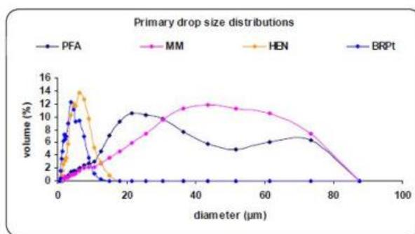
**Figura 4.** Comparación entre las distribuciones del tamaño de gota primaria obtenido con diferentes nebulizadores. ◆ PFA; ◆ MM; ◆ HEN; ◆ BRPt.  $Q_g = 0.7$  L/min;  $Q_l = 0.2$  mL/min. Sympatec HELOS-System.
