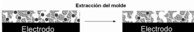
*Esquema ilustrativo de una capa de sílice impresa depositada sobre un electrodo con la molécula molde atrapada en su interior. Tras el tratamiento de limpieza, se consigue liberar los poros para que el analito pueda acceder a través de ellos hasta la superficie del electrodo.*
