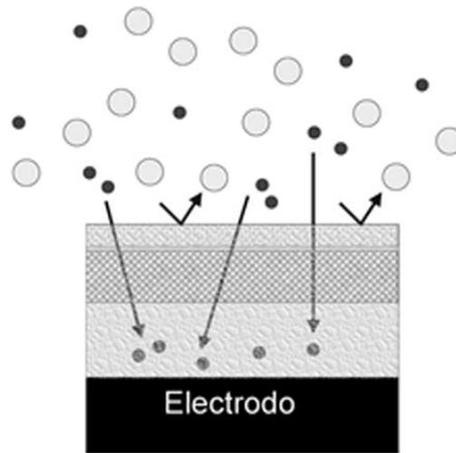
*Una vez liberados los poros del material, éste permite el paso de la molécula de interés evitando el acceso de interferentes hasta la superficie electródica. Posteriormente, el analito será detectado sobre la superficie del electrodo tras atravesar los poros del material.*
