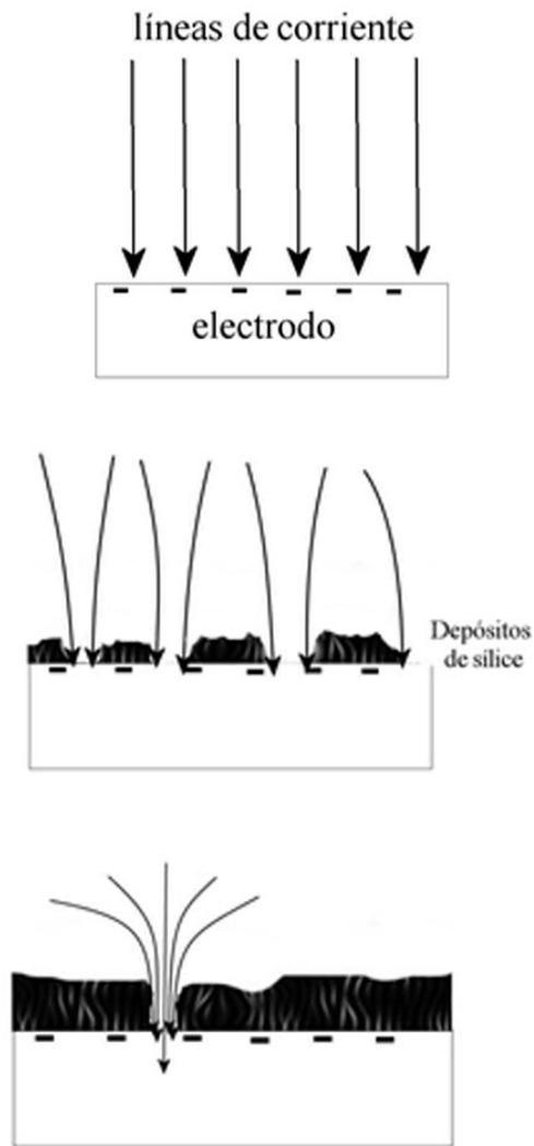
*Muestra esquemática de las líneas de corriente generadas durante una reacción electroquímica y cómo el depósito electroasistido de la sílice modifica la distribución de estas líneas de corriente, promoviendo la formación de un depósito de sílice muy coherente y homogéneo.*
