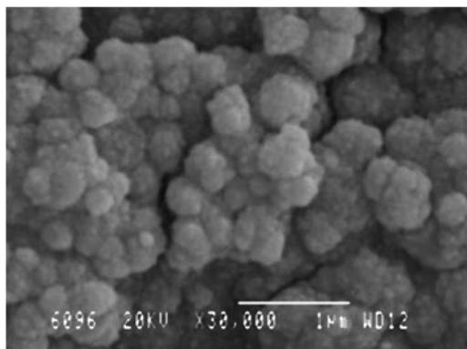
*Micrografía obtenida en un microscopio electrónico de barrido donde se observa el depósito de sílice obtenido sobre un electrodo de carbono vítreo en presencia de dopamina.*
