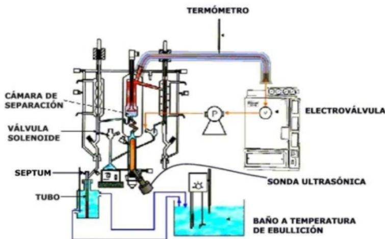
**Figura 2.** Aparato experimental para la determinación del equilibrio
