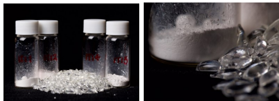
Imagen 1 y 2: viales con los nuevos catalizadores diseñados en la UA, y muestra de plástico transformado en hidrocarburos.
