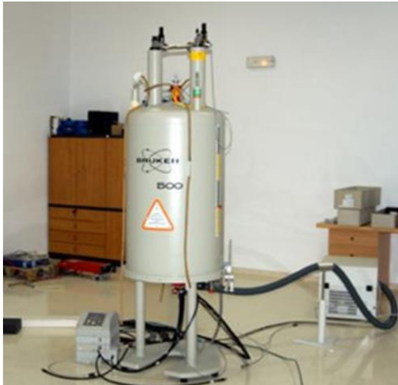
Figura 2. Espectrómetro de RMN de 500 MHz (BRUKER AVANCE DRX500) de los Servicios Técnicos de Investigación de la Universidad de Alicante
