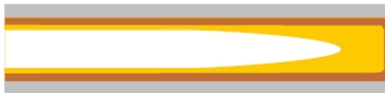
Figura 3. Etapa de compactación con gas.
