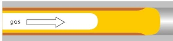
**Figura 2.** Inyección del gas.
