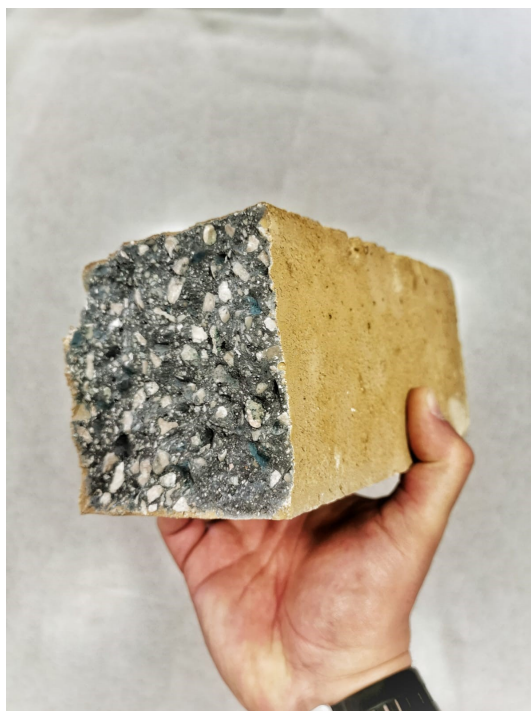
Sección de probeta de hormigón ecológico tras rotura a flexión.
