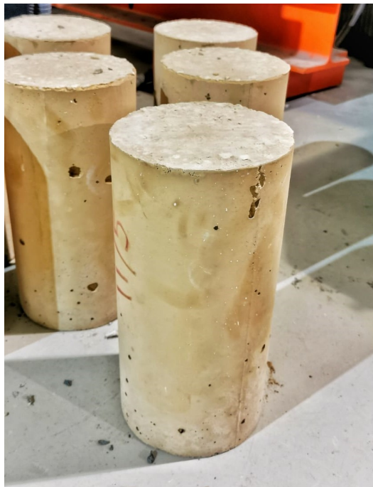
Probeta de hormigón ecológico para ensayos de resistencia a compresión.
