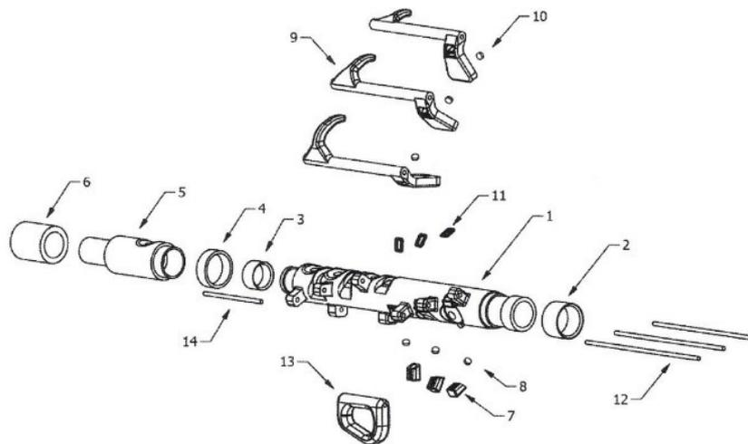
*Figura 1: Vista en perspectiva del cuerpo adaptado de la flauta donde se observan las diferentes piezas que componen el diseño. Base (1), tira ajustable (2 y 3), embellecedor (4), pie (5), protector antideslizante (6), fundas de los imanes (7), imanes (8 y 10), teclas (9), gomas (11), varilla metálica (12 y 14) y anillo de agarre (13).*
