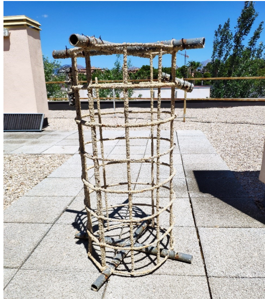
Figura 8: estructura metálica con el recubrimiento calcáreo obtenido por electrólisis.
