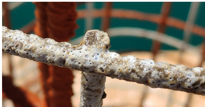
Figura 1: aspecto del recubrimiento calcáreo al finalizar la fase de electrólisis.
