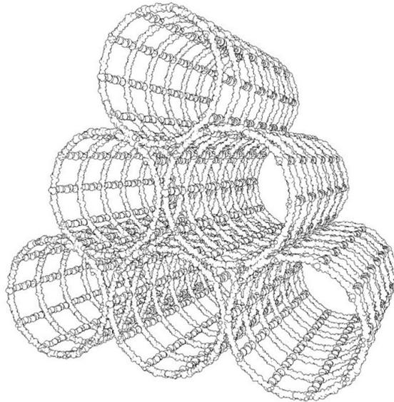
Figura 4: agrupación de seis módulos cilíndricos que podría ser utilizada como sistema de biofiltración tras ser recubierta por organismos del bentos marino sésil.
