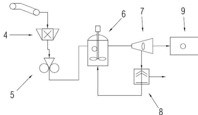
**Figura 2.** Esquema general de las etapas para la eliminación de adhesivos y/o tintas interlaminares en plástico laminado. 4. Molino; 5. Dispositivo de microperforado; 6. Reactor en agitación; 7. Centrifuga; 8. Centrifuga clarificadora; y, 9. Decantador.
