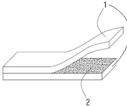
**Figura 1.** Esquema general de un material plástico laminado, el cual comprende al dos menos dos capas de material plástico (1), y una zona interlaminar (2) intercalada entre las dos capas de material plástico (1).
