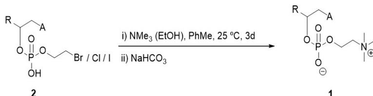
**Esquema 2.** Reacción de sustitución para formar la correspondiente betaína del compuesto con fórmula general (1).
