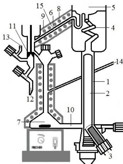
**Figura 1.** Muestra esquemática para la determinación del equilibrio V-L-S y V-L-L-S. 1. Calderín; 2. Resistencia eléctrica recubierta por una vaina de cuarzo; 3. Sonda de ultrasonidos; 4. Bomba Cotrell; 5. Cámara de separación; 6. Conducto; 7. Matraz mezclador; 8. Resistencia eléctrica; 9. Aislante con un termopar; 10. Conducto; 11. Válvula; 12. Salida; 13. Entrada; 14. Conducto; 15. Dispositivo de recirculación.
