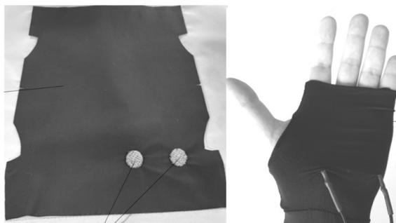
Figura 2: Detalle de la prolongación de la manga de la prenda textil con dos electrodos.
