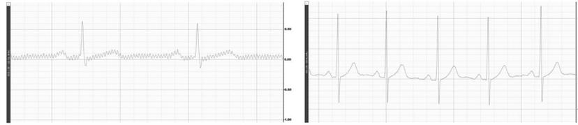
Figura 3: Señal ECG medida con un electrodo plano frente a la medida con un electrodo textil bordado tridimensional, respectivamente.
