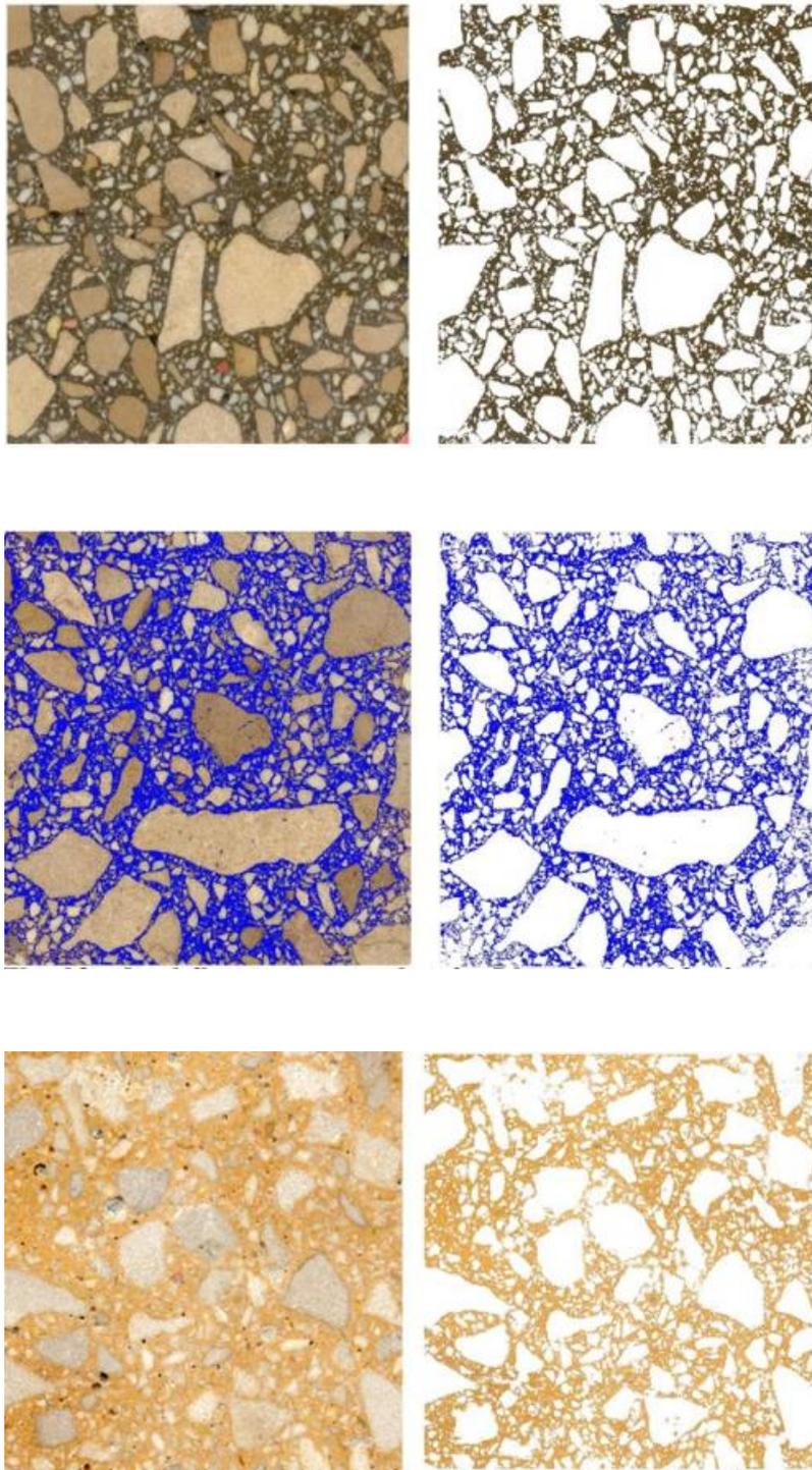
Una vez efectuada la tinción selectiva de la pasta de cemento presente en la muestra de mortero u hormigón, se procede a obtener una imagen digitalizada de la muestra teñida mediante métodos convencionales. Para el análisis de esa imagen digitalizada y la posterior discriminación de la zona teñida se podría emplear cualquier programa informático de tratamiento de imágenes con suficientes
