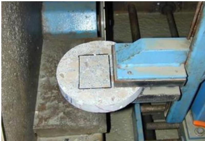
Para aplicar tal método es necesario poner en contacto una muestra de hormigón, que puede ser en forma de lámina delgada como las utilizadas en microscopía óptica, una laja, una probeta de ensayo normalizada o bien una pieza de obra, con un compuesto seleccionado entre las dos opciones que se citan a continuación:
