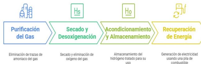
Figura 4. Diagrama esquemático que describe las diferentes etapas del proceso de posttratamiento de la corriente gaseosa de la REN.
