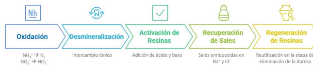
Figura 3. Diagrama esquemático del proceso de posttratamiento de la corriente acuosa que sale del reactor electroquímico.
