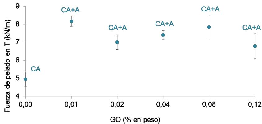
**A : Adhesión; CA : Rotura cohesiva del adhesivo**
