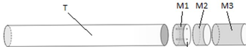
Figura 1: columna de tabaco (T) y filtro combinado formado por: la membrana primaria (M1), la membrana intermedia (M2) y la membrana exterior (M3).
