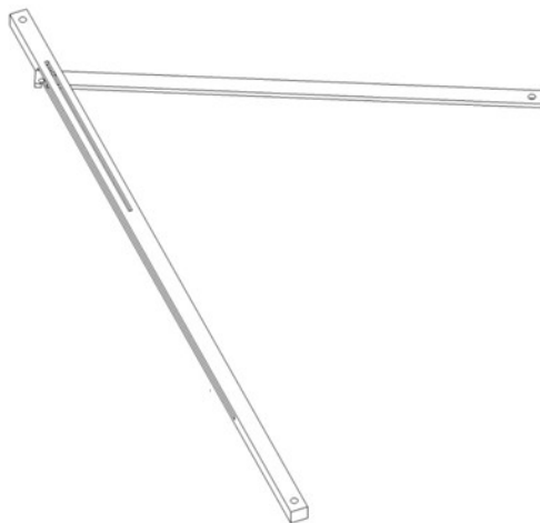
Figura 2: sistema para la fijación de armaduras (pieza principal y pieza secundaria).
