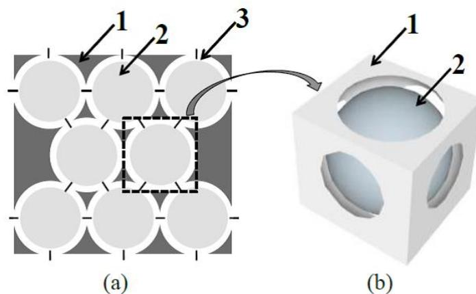
**Figura 1.** Esquema en el que se ilustra la interconexión de poros existentes en un material espumado con matriz estructural (1) y con fase huésped (2) y la manera en que se aloja una partícula huésped en una cavidad porosa (3) del material espumado. (a) dibujo en dos dimensiones en el que las líneas representan aperturas de interconexión entre poros; y (b) representación tridimensional de una fracción de volumen representativa que contiene una partícula huésped alojada en una cavidad porosa.
