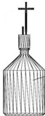
Figura 4: Reservorio para el intercambio de líquidos con el biorreactor.
