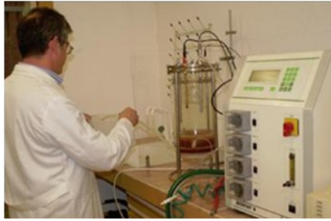
Figura 6: Operación de vaciado del biorreactor.
