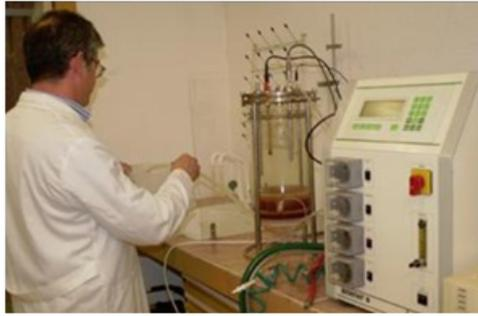
Figura 6: Operación de vaciado del biorreactor.
