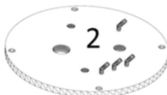
*Figura 2: Diseño de la tapa del biorreactor.*
