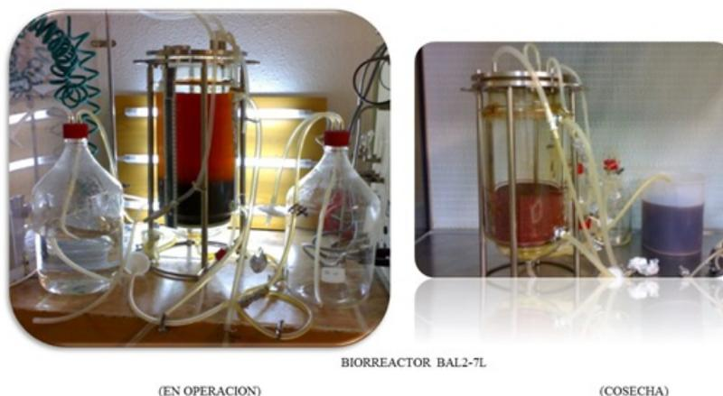
Figura 7: Prototipo del biorreactor.
