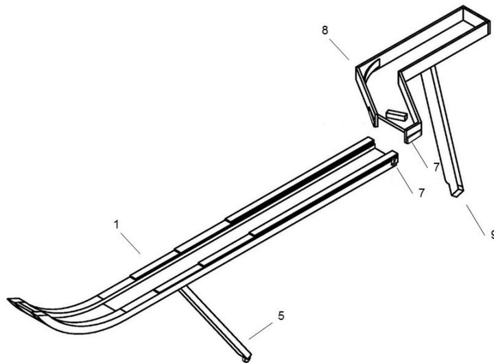
**Figura 3:** Sistema de unión de la rampa de lanzamiento y el soporte de bolas. (1, Rampa de lanzamiento; 5, Pieza de sujeción; 7, Sistema de unión; 8, Soporte de bolas; y, 9, Elemento de anclaje).
