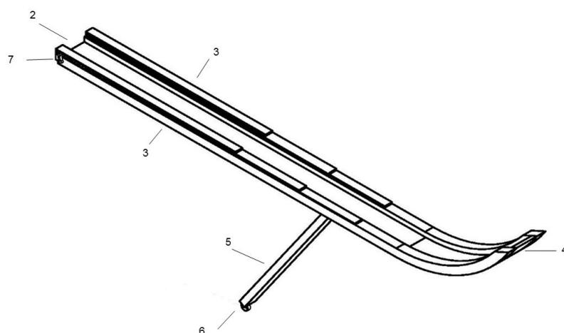
**Figura 1:** Rampa de lanzamiento (2, Base; 3, Guías de lanzamiento; 4, Sistema de deslizamiento por suelo; 5, Pieza de sujeción; 6, agarradera; y 7, Sistema de unión).
