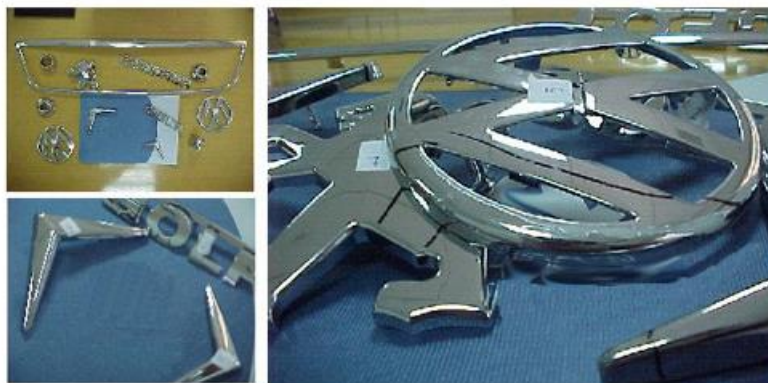
Figura 2. Distintas piezas fabricadas por una empresa de recubrimiento de cromo sobre plásticos
