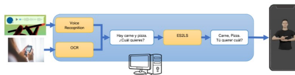
Figura 2: Diagrama de la funcionalidad correspondiente a la generación del signado mediante un avatar virtual a partir de texto o audio introducido por un usuario/a.
