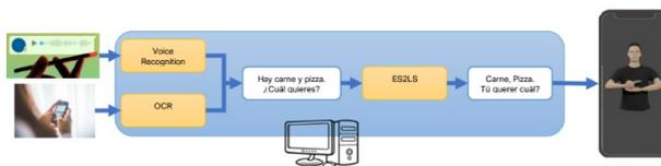
Figura 2: Diagrama de la funcionalidad correspondiente a la generación del signado mediante un avatar virtual a partir de texto o audio introducido por un usuario/a.
