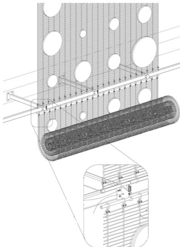
Fig. 3. Muestra del sistema en el que se ancla mecánicamente a tope una pletina con su extremo en forma de gancho para sujeción (colocación del extremo superior).
