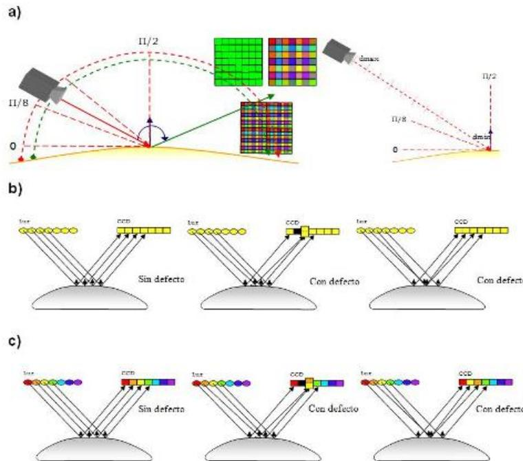
Figura 2. Estudio de parámetros del entorno para amplificar los defectos. a) Configuración de ángulos y distancias de percepción. b) Configuración de luz homogénea. c) Configuración con luces de distinta longitud de onda.
