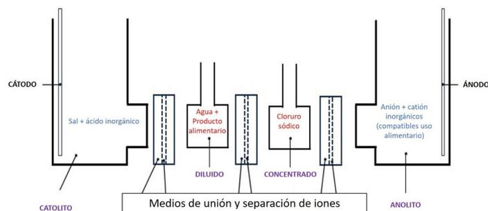
Figura 1. Esquema de una vista frontal del dispositivo.
