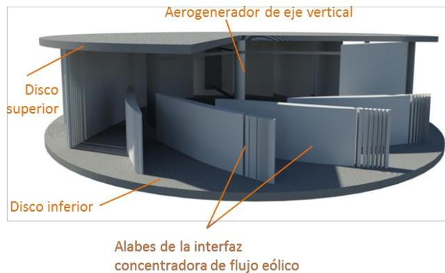
Las brisas eólicas circulantes sobre la superficie terrestre se caracterizan por su intermitencia, reducida velocidad y ausencia de dirección predominante. EOLIA es capaz de suplir la baja densidad energética de las brisas circulantes sobre la superficie terrestre mediante su captación y concentración, consiguiendo un incremento significativo de la velocidad antes de ser inyectada de manera eficiente en la turbina.
