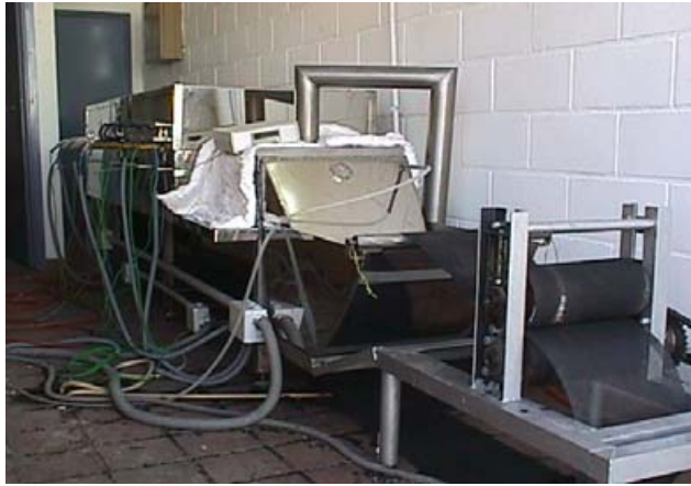
Figura 4. Planta piloto para la fabricación de ropa de carbón activado
