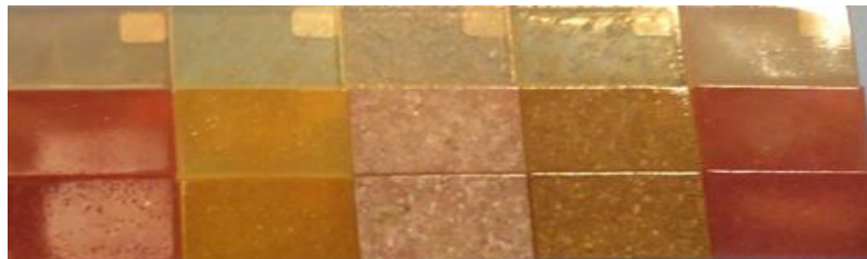
Figura 3. Nanocompuestos con bioresina epoxy y nanopigmentos a partir del colorante natural de extracto de raíz de remolacha (betanina), en diferentes condiciones de síntesis.
