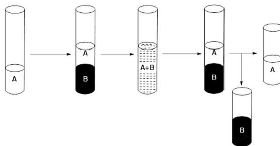
Figura 5: Esquema del proceso de extracción selectiva.
