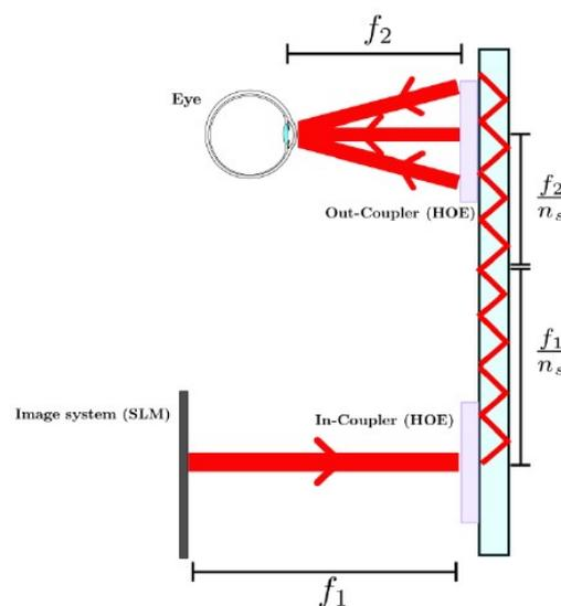
Figura 1: Diagrama del funcionamiento de las lentes holográficas
