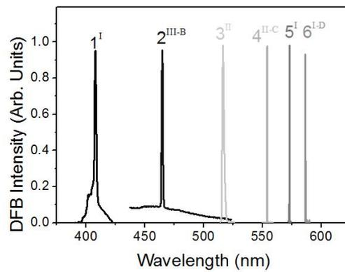
Figura 5. A continuación se muestra los espectros de emisión de diversos láseres DFB basados en películas de PS que contienen COPV6, con el objetivo de ilustrar la capacidad de sintonización de la longitud de onda de emisión para un derivado de COPV dado, cambiando el espesor de la película activa o el periodo de red del dispositivo.
