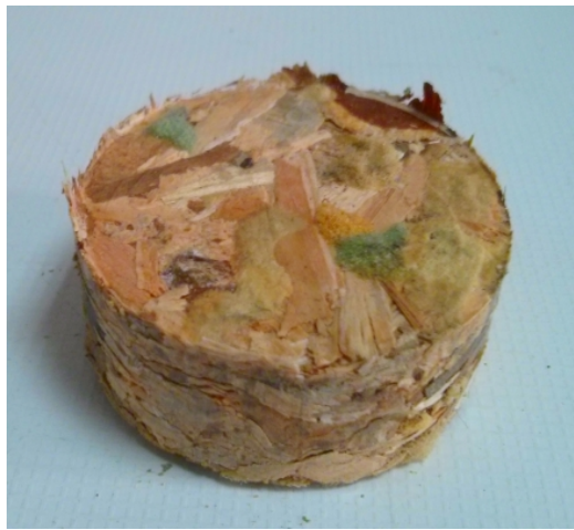
Figura 2.- Briqueta obtenida con la mezcla de residuo de mueble y espuma de poliuretano
