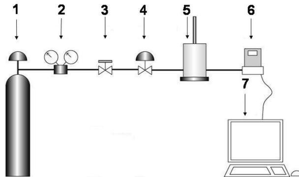
*Figura 1: Esquema del equipo de medida de la autorreparación de materiales: 1- Bala de gas; 2- Regulador de presión; 3- Válvula de corte; 4- Válvula de control del flujo de gas; 5- Cuerpo principal; 6- Medidor de flujo; 7- Dispositivo de adquisición de datos.*
