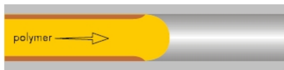
Figura 1. Llenado del polímero hasta un porcentaje predeterminado de la cavidad.
